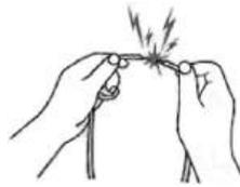
No conecte ni modifique el cordón eléctrico durante la instalación.
